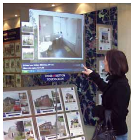
SmartGlass kan kombineres med en touchfilm slik at glasset blir en interaktiv flate (touch screen).
